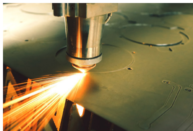
б) Промышленная резка металла углекислотным лазером
