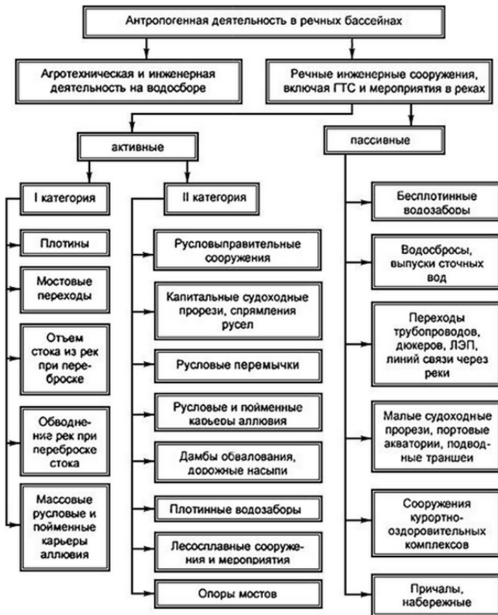
Рис. 5. Классификация речных инженерных сооружений, включая гидротехнические сооружения (ГТС), и мероприятий по характеру взаимодействия с русловым процессом
