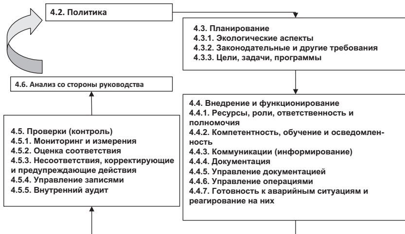
Рис. 7. Нумерация и структура раздела 4 стандарта, пункты которого содержат требования к СЭМ. Пункт 4.1 (Общие требования) не показан намеренно
